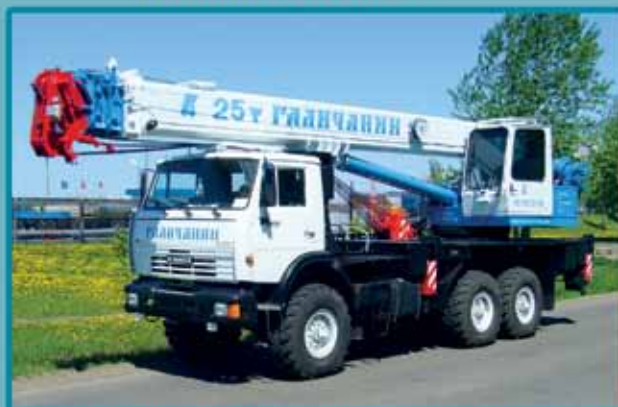
КС-55713-5В, 25 тонн, стрела 28 м, камаз-43118 (6x6)
