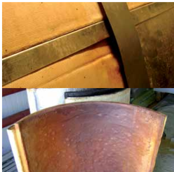
Рисунок 3. Ослабление бандажа в результате карбонизации однослойных скорлуп при t=150^{\circ}\text{C}
