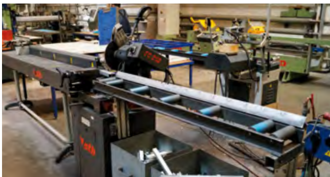
Пила для резки стального армирования
