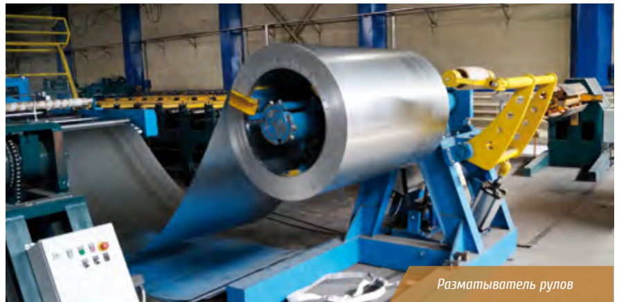
Линия продольно-поперечного раскроя рулонного металла
