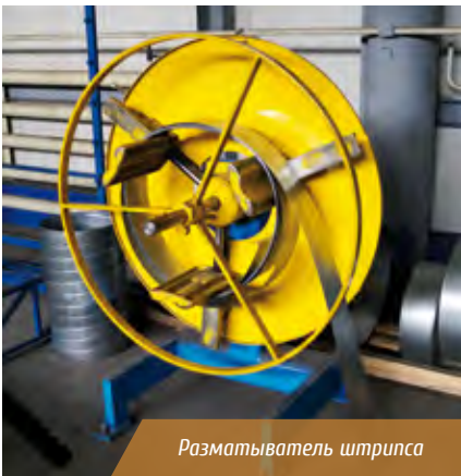
Линия продольно-поперечного раскроя рулонного металла
